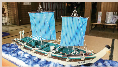
▲義二さんが祖父から聞いた話や自身の記憶を頼りに、令和2年に作成した「小早船」の模型。海の神様を祭る駒形神社に奉納された。小早船は八丁櫓船とも呼ばれ、7～10本の櫓を船員が漕ぎ、人力だけで140*ほど離れたカツオ漁場に向かった。
