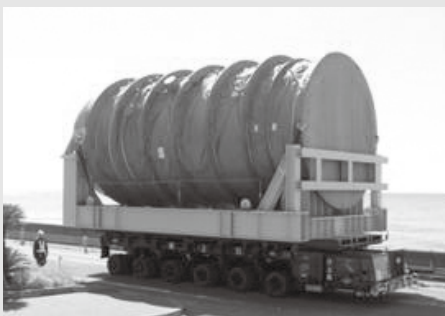
▲フィルタベント設備を輸送する様子
