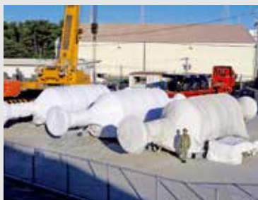
▲クリアランス制度の適用を受けた5号機旧低圧タービンロータ(車軸)
