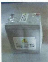
変形したバッテリー
