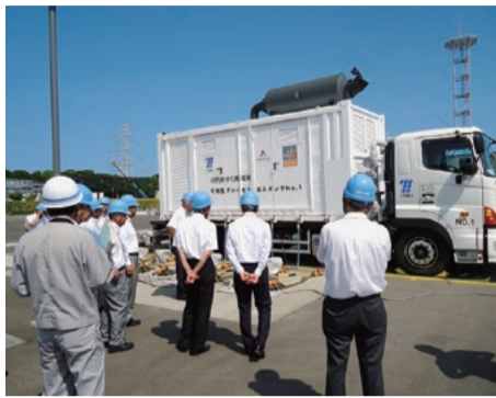
可搬型ディーゼル注入ポンプ
