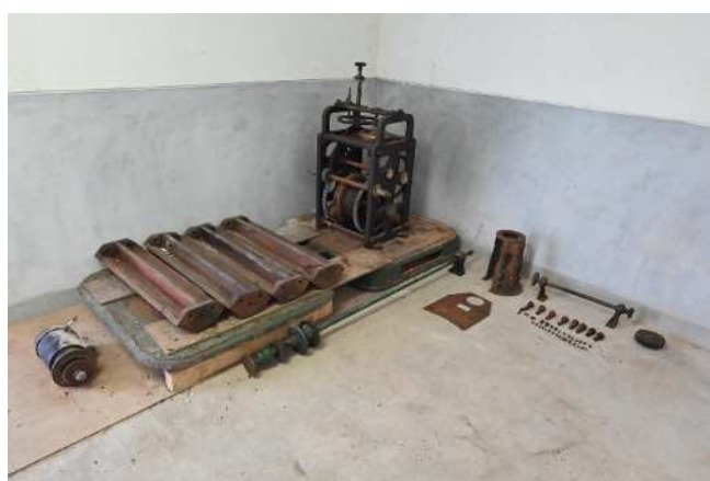
6 旧回転機械分銅自動巻揚装置近景
