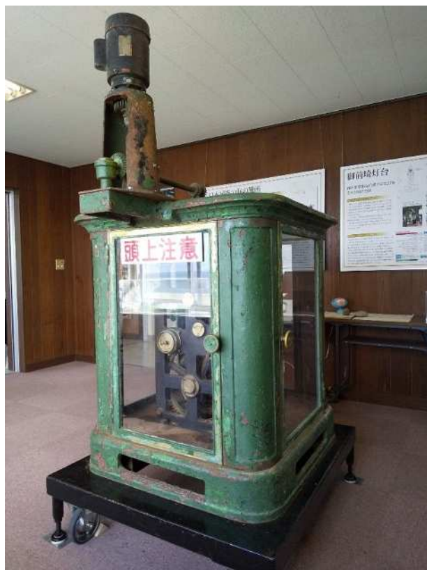
写真2 国重要文化財附指定 旧回転機械分銅自動巻揚装置
