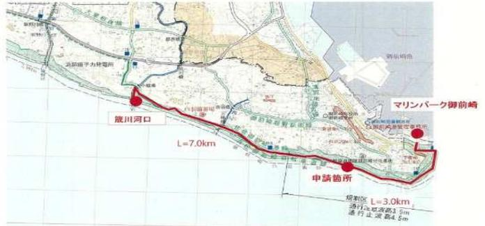
第13図 海岸養浜工事運搬経路
