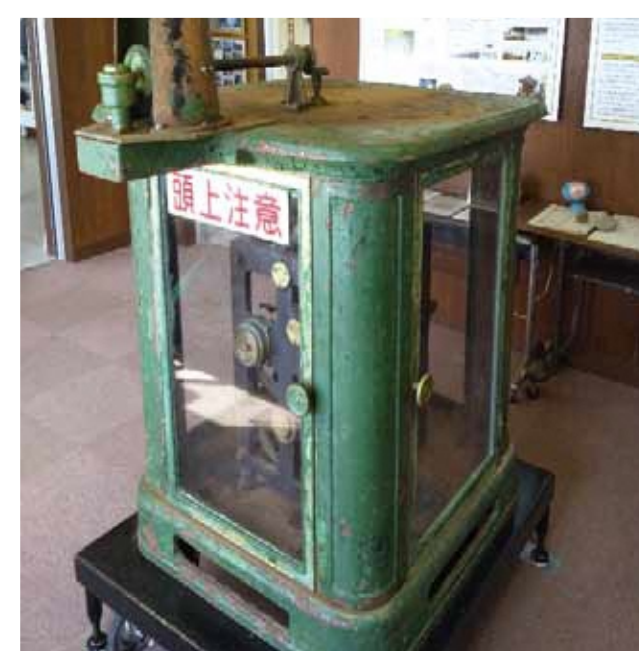
御前埼灯台資料館に展示された「旧回転機械分銅自動巻揚装置」
