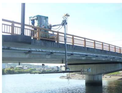
図 4.1.1 橋梁点検支援ロボット + 橋梁点検調書作成支援システム（参考）NETIS 登録技術
